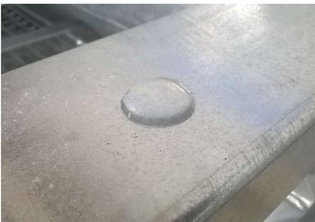
Châssis en acier haute résistance, soudé, galvanisé à chaud et entièrement passivé. Résistant à la corrosion, brillant et hydrofuge.
