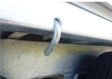
8 crochets sur le bord du châssis, fortement soudés à l'intérieur.
