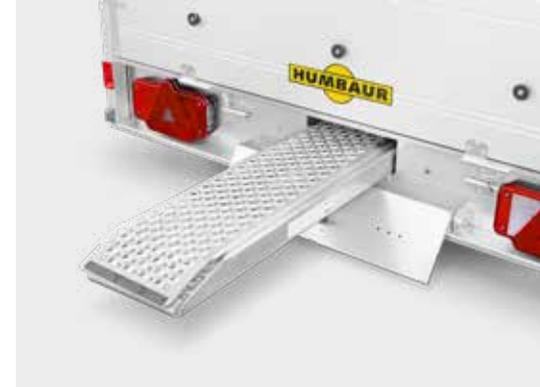
Des rampes de chargement en aluminium en option peuvent être insérées dans la protection anti-encastrement
