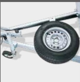
Support de roue de secours monté sur le timon
