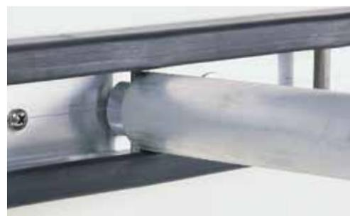
Rail d'arrimage à barreaux avec barre de blocage
