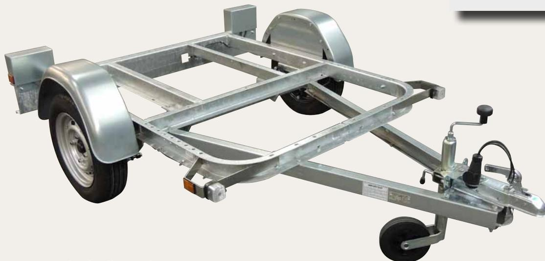
Le type CMS offre un format compact de 160 x 122 cm utiles. Très maniable, ce châssis permet le transport aussi bien d'éléments techniques (compresseurs, caisses, groupes...) que de loisirs (vélos, scooters, chasse...). Une caisse additionnelle est proposée en option sur cette référence.
