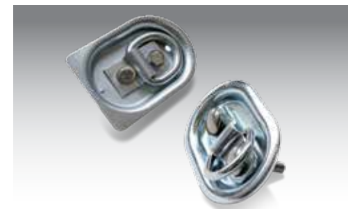
Anneaux de fixation montés encastrés dans le plancher en bois, force de traction de 0,2 t chacun (4 pièces) ou de 0,4 t (4 ou 6 pièces)
