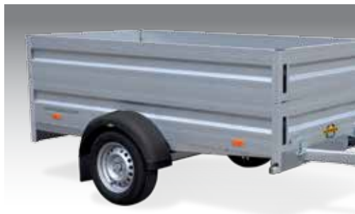
Réhausse de ridelle de 350 mm (de 300 mm sur la Startrailer)
