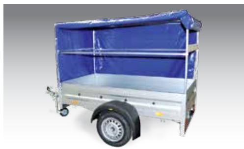
Bâche et arceaux, hauteur de chargement 1 000/1 300/1 600/1 800 mm (exécution selon le modèle)
