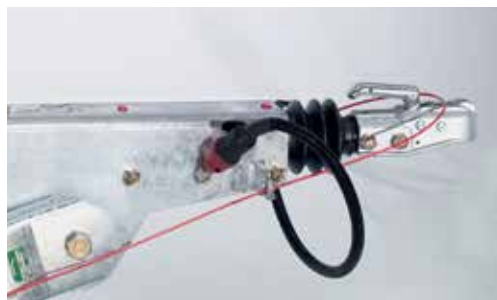
Attelage à boule de timon réglable, 2 000 kg - 2 500 kg et 3 000 kg - 3 500 kg
