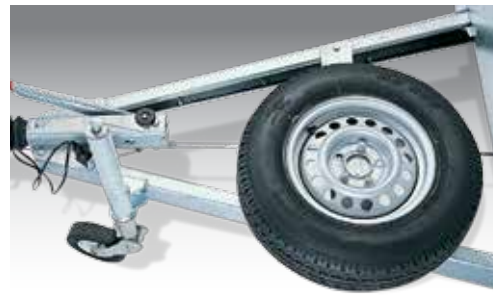
Roue de secours montée sur timon (uniquement possible avec option timon long)
