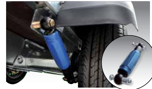
Amortisseurs montés (et non montés) pour ou sans limitation de vitesse 100 kmh
