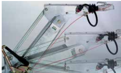
Timon réglable en hauteur (attelage sur rotule et anneau d'attelage DIN non compris)
